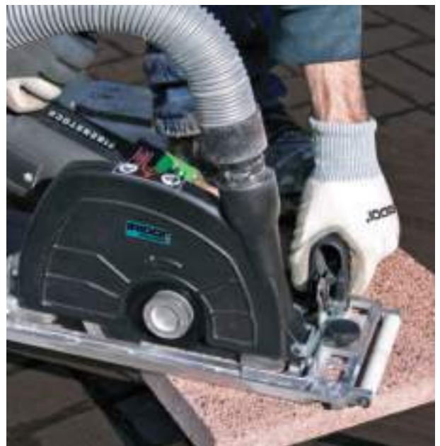
Corte preciso de baldosas con aspiración, sin polvo
