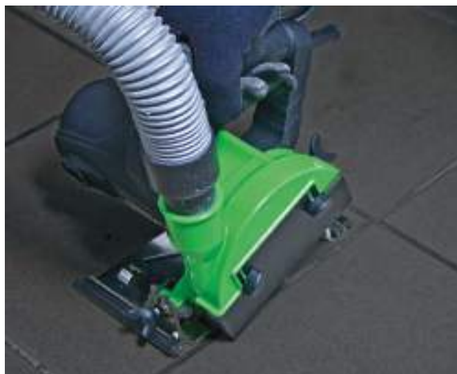
Corte preciso baldosa de gres porcelánico con aspiración
