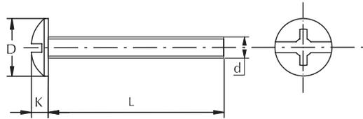
• Tornillo embellecedor combi para ensamblaje de muebles.
