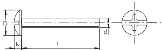
• Tornillo embellecedor combi para ensamblaje de muebles.
